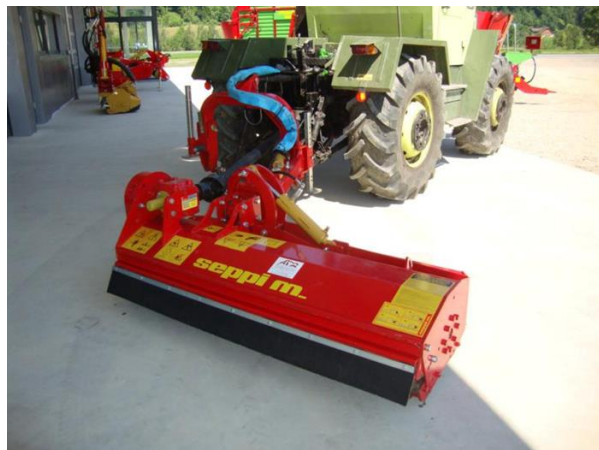
Broyeur déportable et orientable (Agro-Technique Zulliger Sàrl, 2022).
